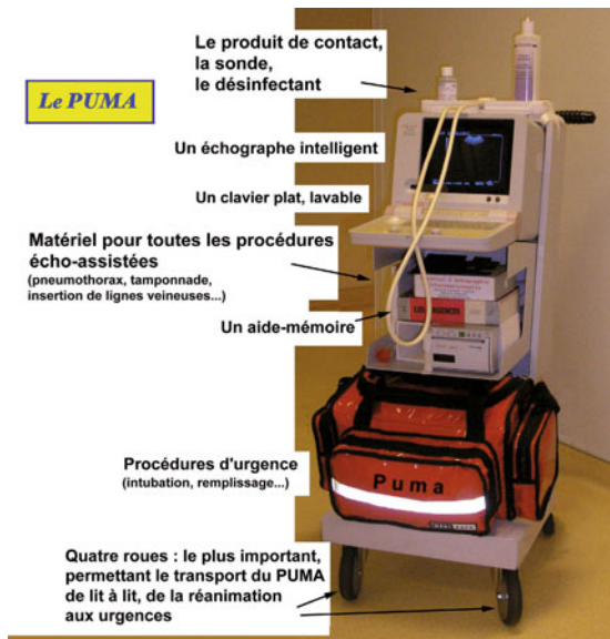
Fig. 30.5 – Le concept PUMA. Cette figure veut juste montrer que l'échographie n'est qu'une partie de la prise en charge du patient. Le PUMA ( Polyvalent Ultrasound and Management Apparatus ), exploitant la 3 e dimension (la hauteur), permet des procédures illimitées chez le patient critique. Il ne fait pas encore de café (ce qui pourrait être envisagé car il reste de la place en haut – un espace destiné à détendre l'équipe une fois le diagnostic promptement fait et le patient stabilisé), mais ce clin d'œil indique juste ce qu'est l'échographie critique : une médecine visuelle qui rend tout plus rapide et plus simple.
