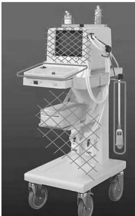
Fig. 3.1 – Partition bactériologique de notre appareil. Seules les parties cerclées ont besoin d'un contact, et seront désinfectées après usage. On voit ici qu'un clavier plat se désinfecte immédiatement. Une sonde unique peut et doit être désinfectée avant d'être remise sur son stand. Sinon, il faut désinfecter le stand, ce qui est très contraignant. Il est inutile de toucher l'ensemble des parties rayées.
