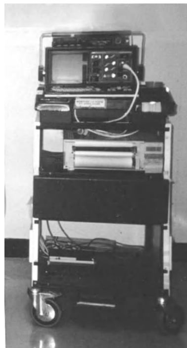
Fig. 2.2 – L'ADR-4000®, fabriqué par ATL : une référence. Cet appareil respectable était moins encombrant que certains laptops actuels : sa largeur était de 42 cm, et il pouvait grâce aux roues être transporté au lit du patient, réalisant la révolution de l'échographie critique depuis 1982. Voir aussi la figure 30.4, p. 294, montrant l'aptitude de cet appareil pour développer l'échographie pulmonaire.
