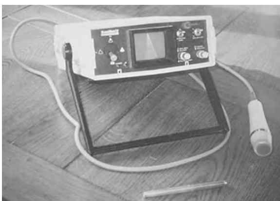
Fig. 28.1 – L'antique Dymax TM-18. C'est l'échographe que nous avions en 1995 pour le Paris-Dakar. Cette machine, avec cinq boutons, aucun espace perdu pour enregistrer des images, une seule sonde, et une batterie, c'est-à-dire une autonomie complète, préfigurait le « stéthoscope » moderne. Le stylo indique la taille de la machine.
