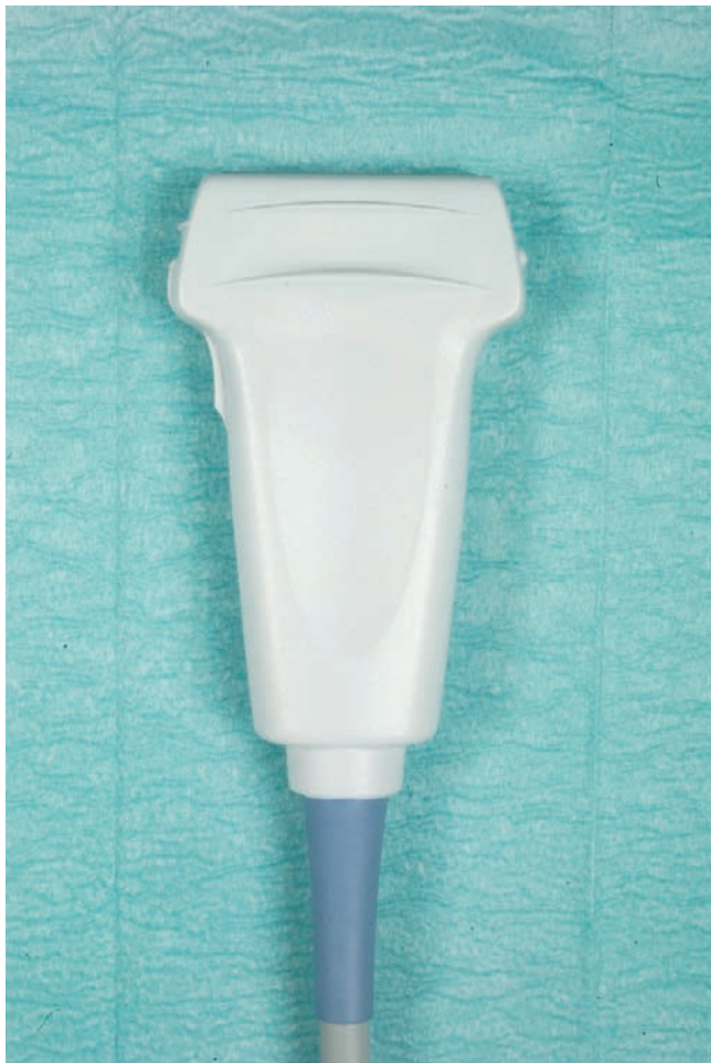
Figure 12.3. Sonde échographique linéaire HFL 38/13-6 MHz (MicroMaxx ® , SonoSite).
