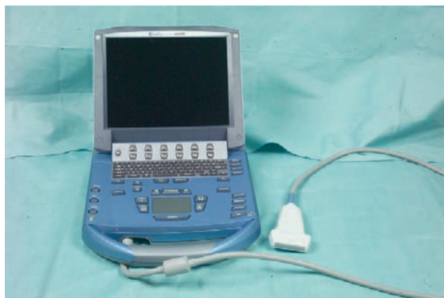
■ Figure 12.1. Échographe portable avec sonde échographique linéaire HFL 38/13-6 MHz (MicroMaxx®, SonoSite).
