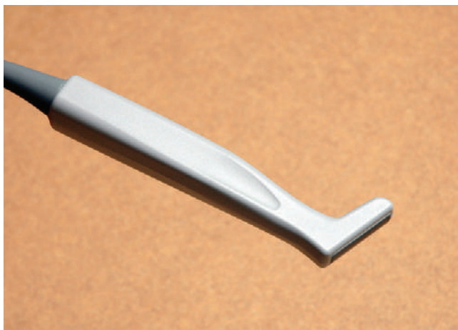
■ Figure 13.3. Sonde linéaire large fréquence de 26 mm en « club de golf » SonoSite MicroMaxx ® (SLA/13-6 MHz, référence P05174-10).
