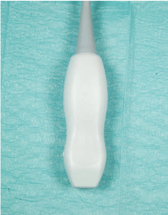
■ Figure 12.18. Sonde linéaire P10/8 MHz (MicroMaxx ® , SonoSite).
