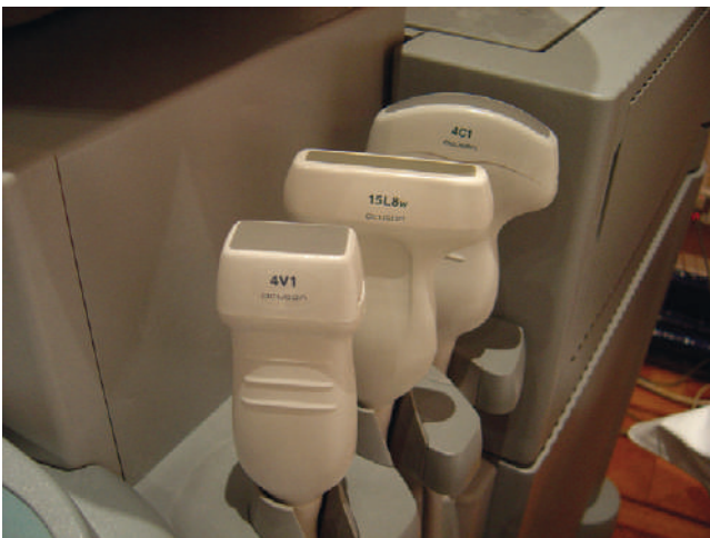
■ Figure 7.2. Sondes échographiques de secteur, linéaire et curviligne.
